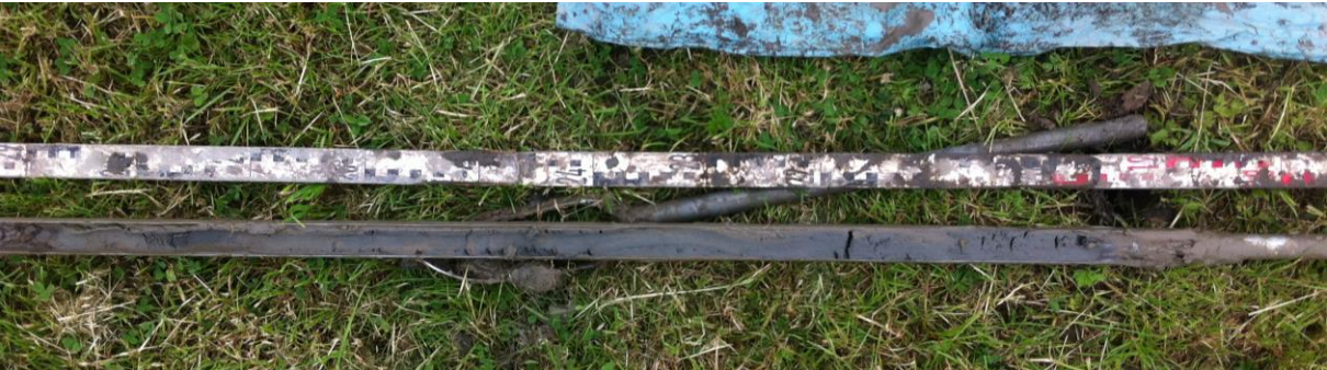
Opname van boring 6. Geulafzettingen
