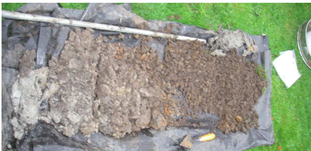
Fig. 3.2: Boring 1: Van oorsprong een beekerdgrond, op 50-60 cm – mv een laag met fragmentjes baksteen
