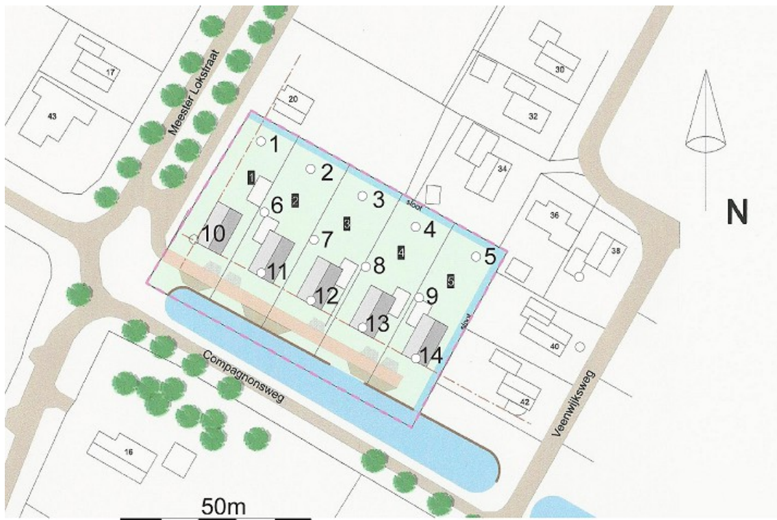
Figuur 4. Ravenswoud, Meester Lokstraat. Boorpuntenkaart. De genummerde cirkels geven de uitgevoerde boringen weer. [Bron: Bouwkundig Tekenbureau J. Kok.]
