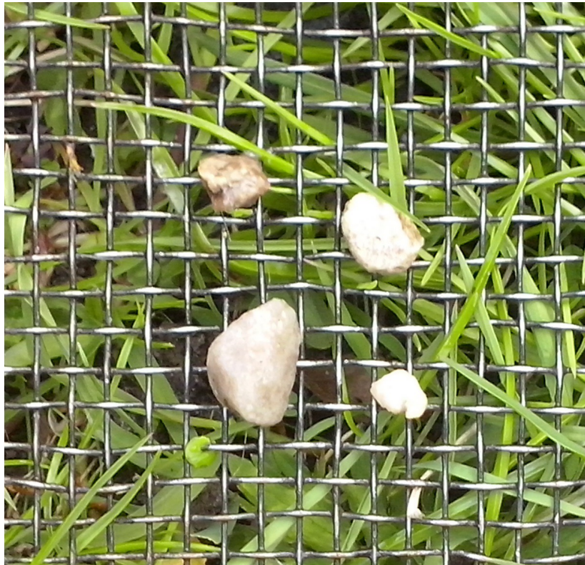
Figuur 6. Ravenswoud, Meester Lokstraat. Grinddeeltjes zoals deze tijdens het zeven op alle boorpunten zijn aangetroffen.
