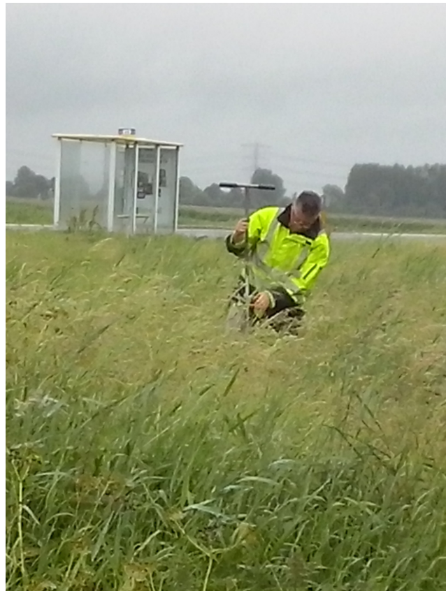
Figuur 11: Groningen, N360, verkennend booronderzoek locaties 3, 9 en 13. Het plaatsen van boring 6 op locatie 13 (gezien vanuit het westen).
