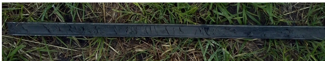
Figuur 7: Groningen, N360, verkennend booronderzoek locaties 3, 9 en 13. Foto van de matig slappe klei met daarin enkele zandlaagjes die op locatie 9 tussen 0,5 en 2 meter beneden het maaiveld is aangetroffen.
