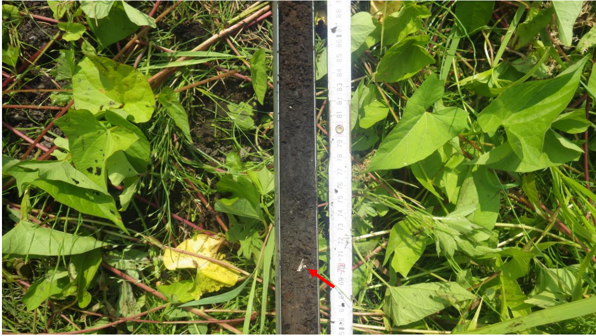
Boring 2: stukje plasticfolie op 70 cm –Mv.
