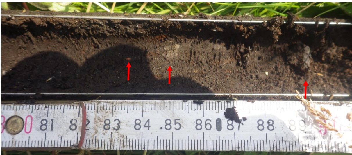
Boring 1: detailopname veraard kleilig veenniveau met daarin zichtbaar kleibrokjes en een spikkel rood-oranje aardewerk/baksteen (75-90 cm –Mv) .
