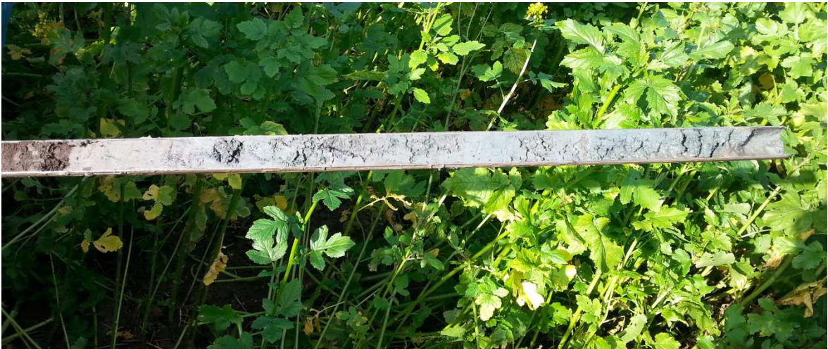
Afbeelding 3 Foto van de Laag van Wijchen en afdekkende veenlaag in boring 6.
