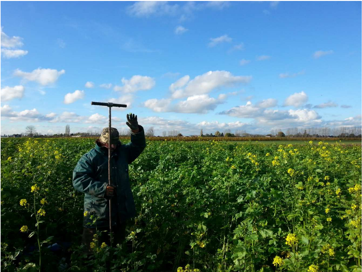
Afbeelding 2 Veldsituatie tijdens het zetten van een verkennende boring in het plangebied.
