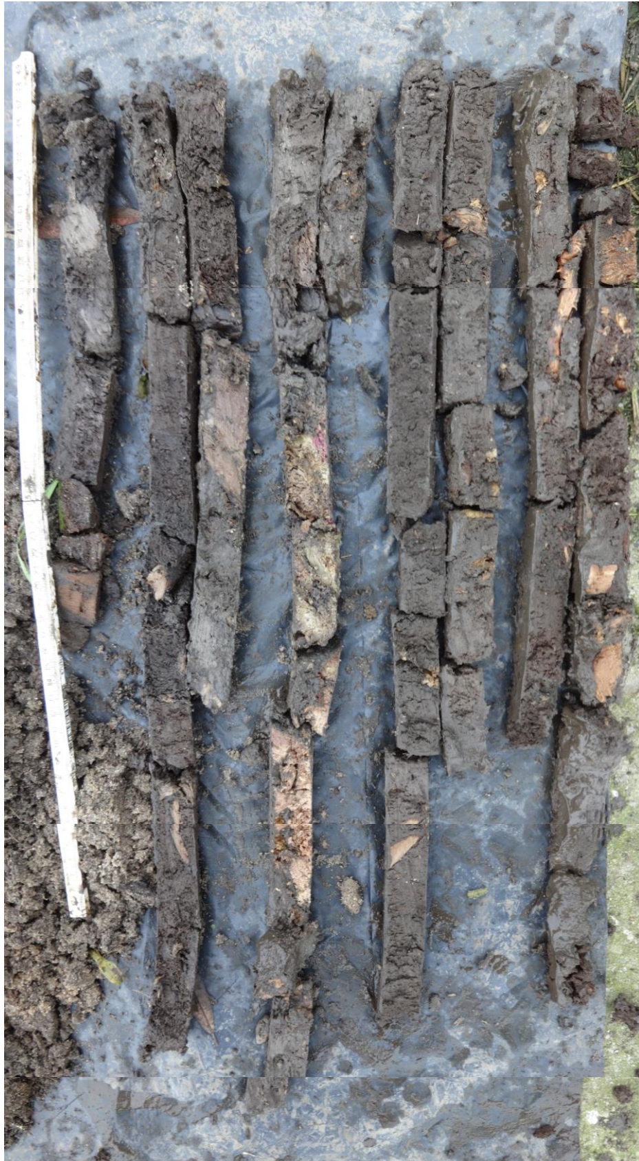
Boring 4: Detailopnamen boekernen steekguts.
