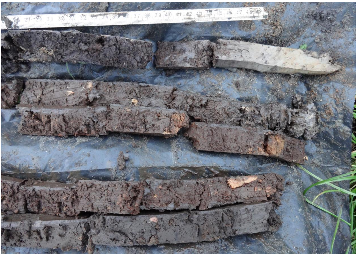
Boring 3: Detailopname boorkernen steeguts, bovenste delen.
