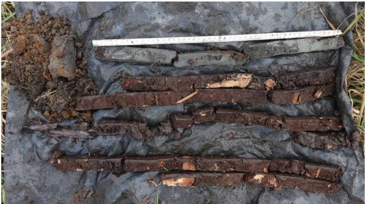
Boring 5: Totaaloverzicht boorkernen.
