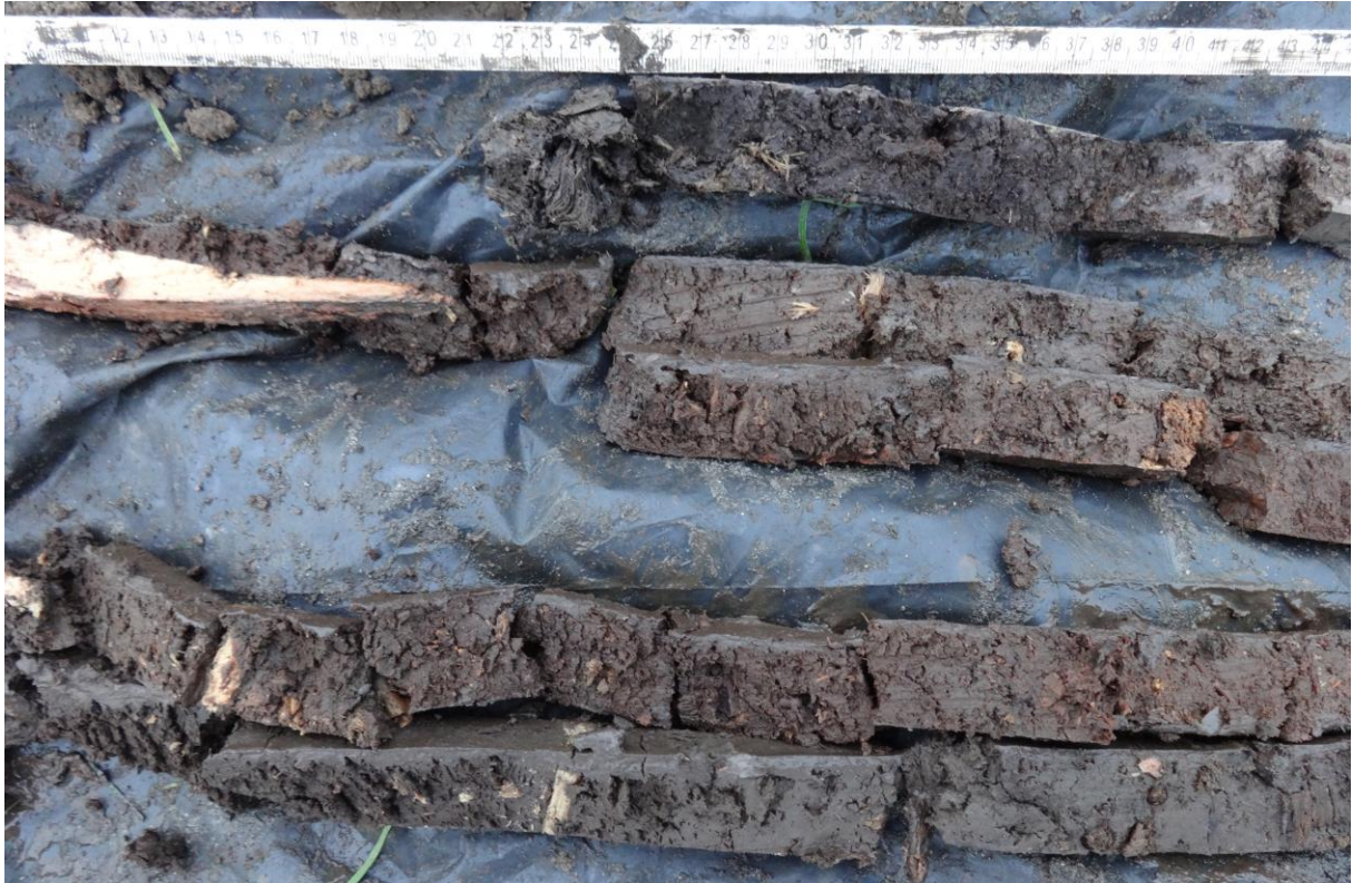
Boring 3: Detailopname boorkernen steekguts, middendelen.
