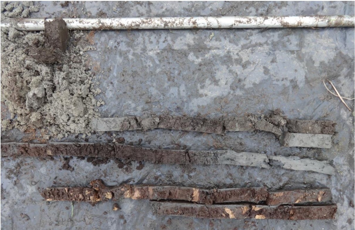
Boring 1: Totaaloverzicht boorkernen.
