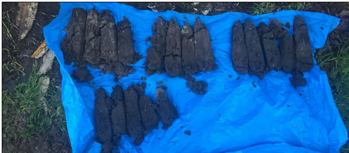
Boring 2: 0-200 cm -Mv. Dieper gelegen sediment liep uit de boor onder invloed van de grondwaterstand.
