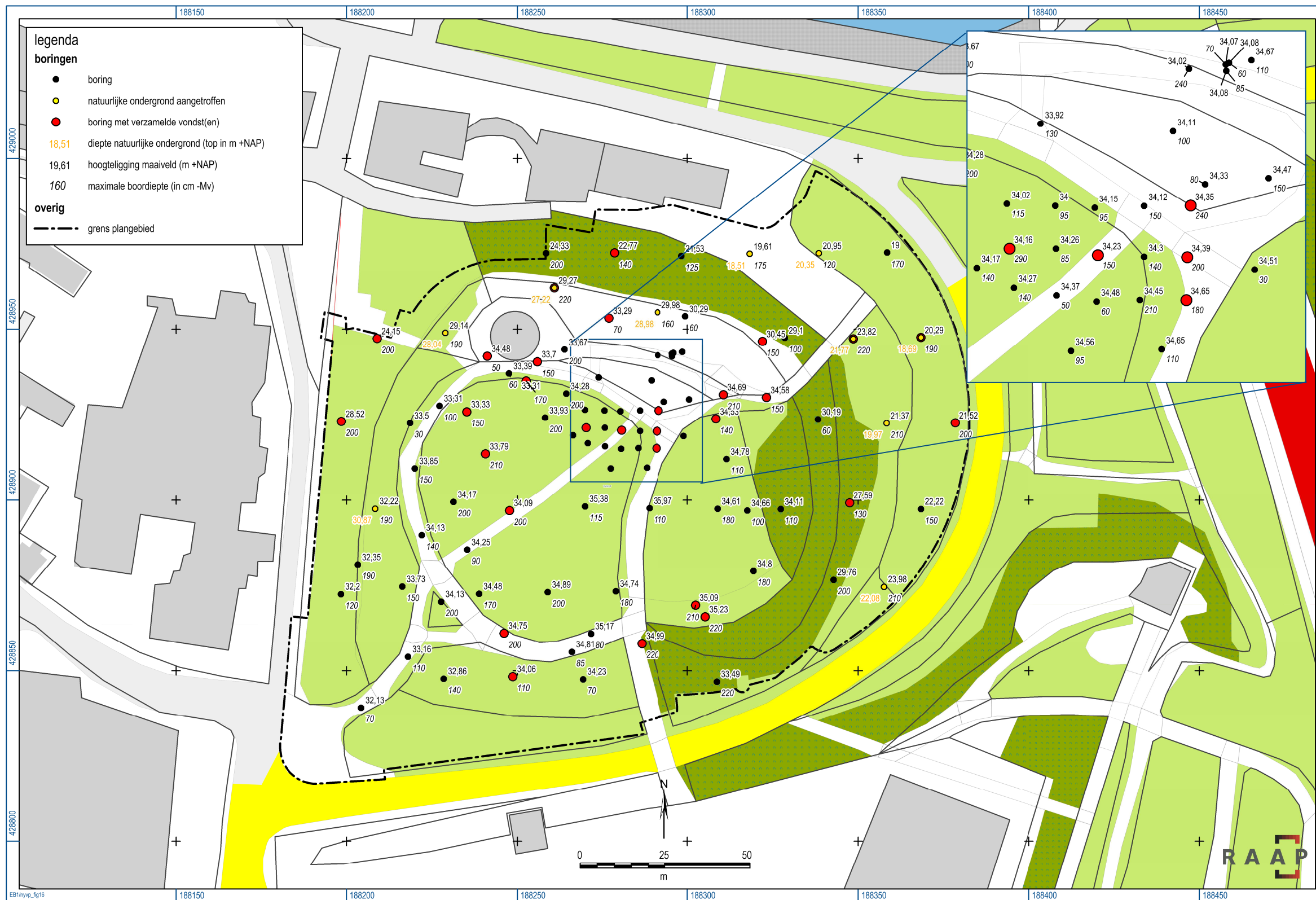
Figuur 16. Boorpunten met hoogteligging maaiveld, maximale boordiepte, boringen waarin dateerbare vondsten zijn aangetroffen en de boringen waar de natuurlijke ondergrond is aangeboord.
