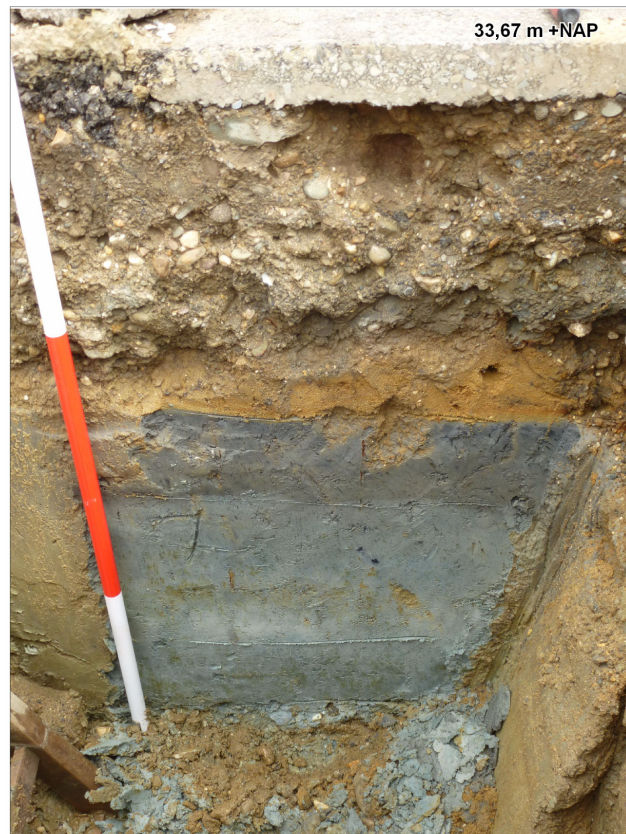
Afb. 7. Profielkolom van proefput 7 met verblauwing veroorzaakt door reductie.
