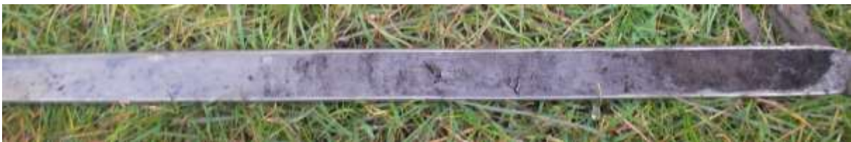
Figuur 14: Foto van de geleidelijke overgang tussen veen en klei zoals deze in alle boringen rond een diepte van twee meter beneden het maaiveld is aangetroffen.
