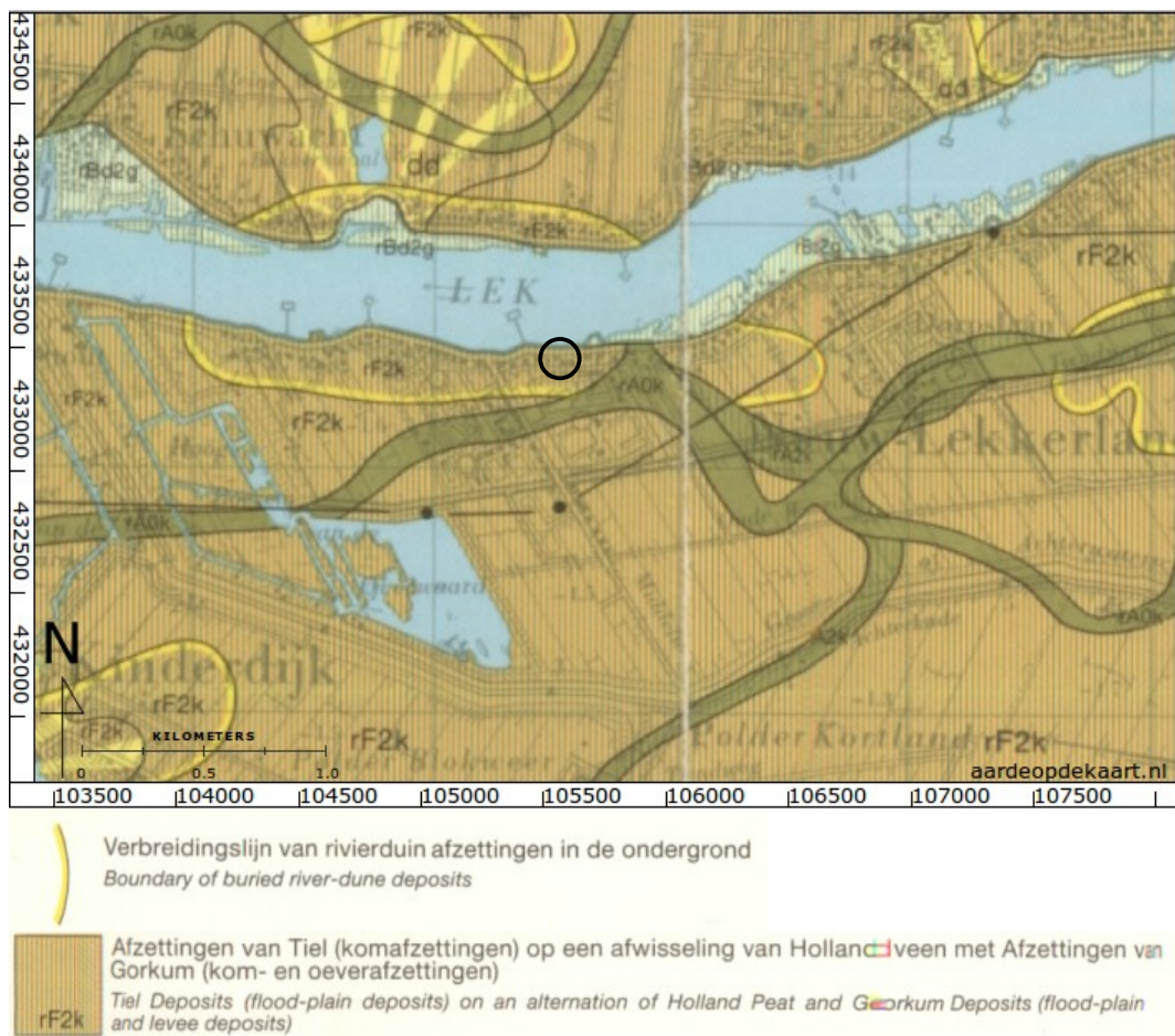
Figuur 6: Uitsnede uit de geologische kaart blad 37 West (Van Staalduinen 1979). Het plangebied ligt in de zwarte cirkel. De top van de rivierduin bevindt zich tussen -12 m en -10 m NAP.
