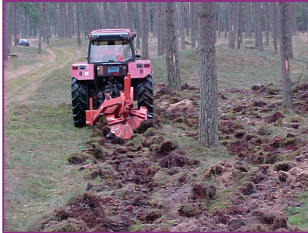
Afbeelding 16: Ter illustratie een afbeelding van een bosploeg. In tegenstelling tot een traditionele akkerploeg wordt slechts één ploegvoor achter de tractor getrokken. Bron: http://www.ebolabv.nl/index.php/diensten
