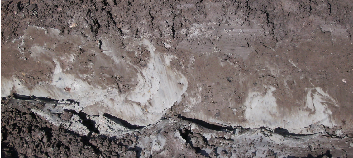
Afbeelding 5.4 Verspitting van de overgang van de oude blauwe zeelei naar het bovenliggende veen. (foto M. Osinga)
