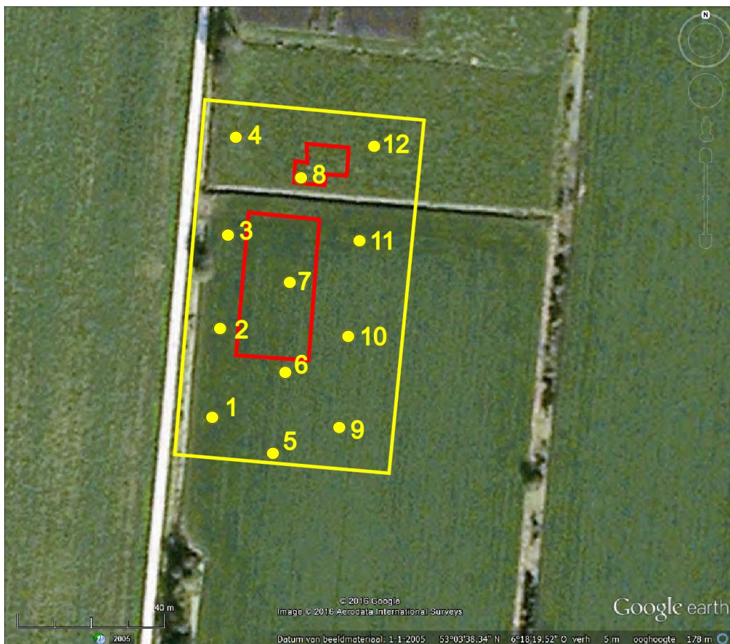
Figuur 11: Haulerwijk, Kerkstraat 61: situatietekening met de boorlocaties. De begrenzing van het plangebied is met een gele lijn aangegeven. De boorlocaties zijn met gele stippen weergegeven. De toekomstige bebouwing is met een rode lijn ingetekend. Voor de RD-coördinaten wordt verwezen naar Tabel 1 en naar Appendix IV.
