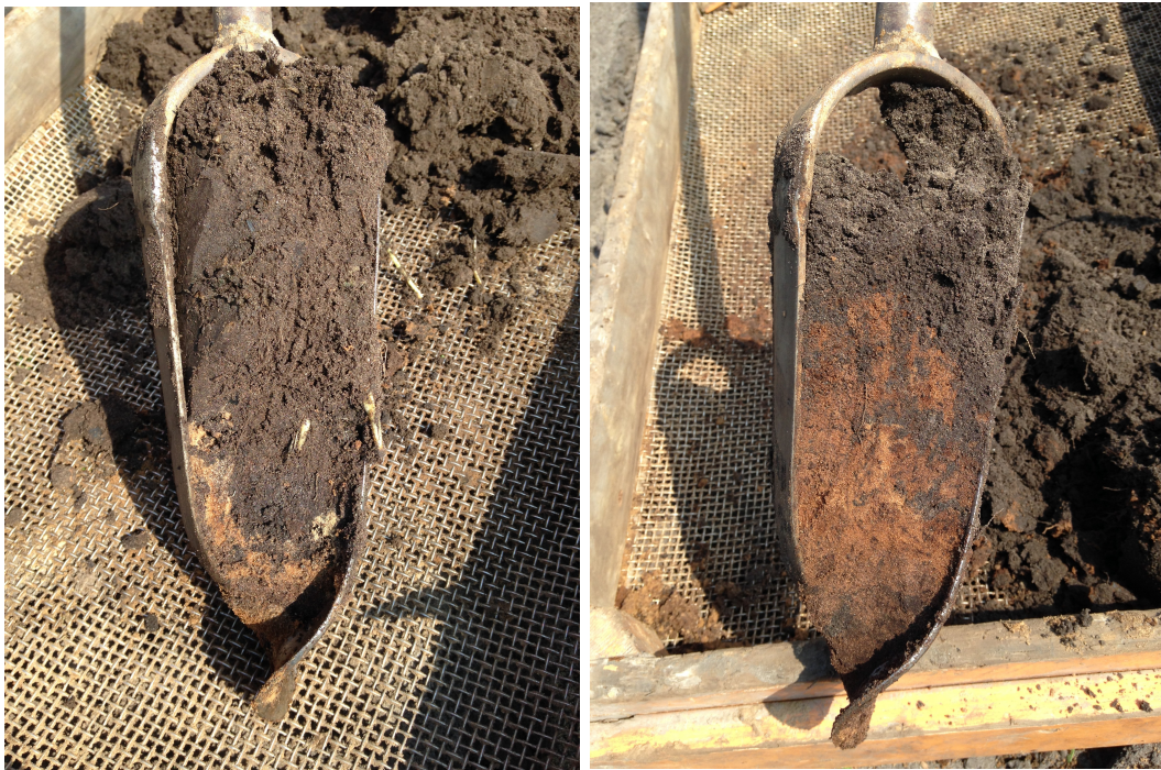
Figuur 13: Haulerwijk, Kerkstraat 61: de linkerfoto laat boring 2 zien: onder de bouwvoor is een verstoorde C-horizont aanwezig. De rechterfoto boring 6, waarbij de bouwvoor gevolgd wordt door een verploegde B-restant.
