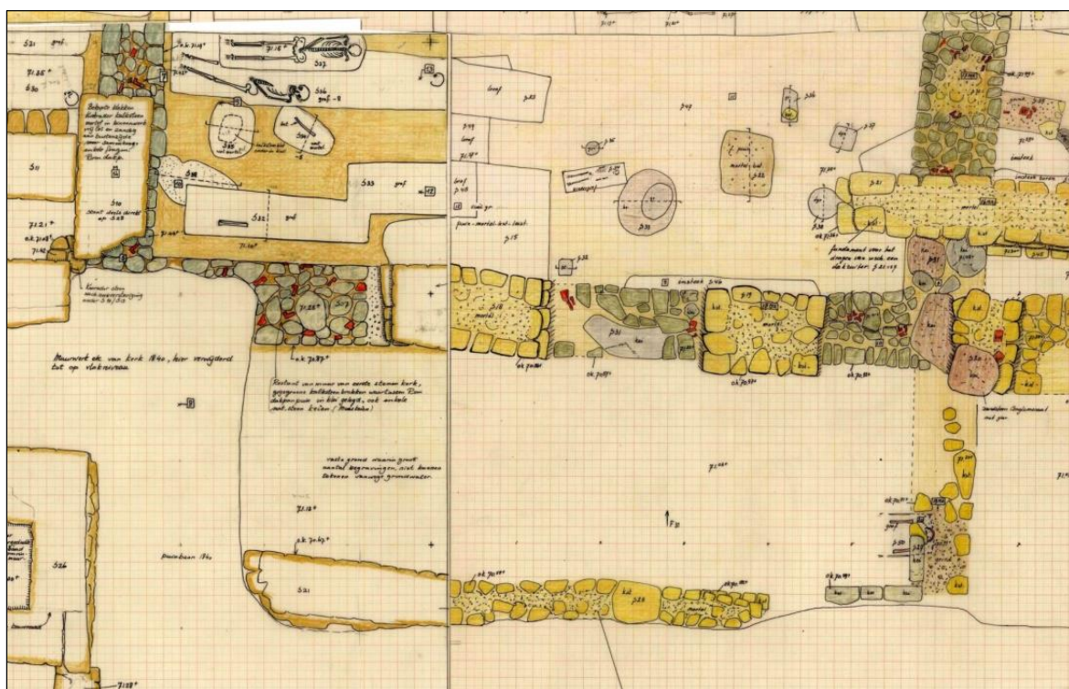
Afb. 78. Werkput 4 (links) en werkput 5 (rechts), vlak 3 (uitsnede). Noordzijde van het schip van de kerk met (onder) de noordelijke zijbeuk (S4/21). Op de noordmuur (S5/31) van het eerste schip staan poeren (S5/18, S5/19) van scheibogen waardoor de zijbeuk toegankelijk was. Deze poeren horen echter bij bouwphase 7. Zie ook afb. 90.
