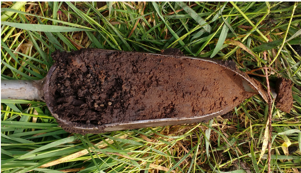
Figuur 12: Meedhuizen, Essenlaan 11: de bruin gekleurde B-horizont van boring 2 in de kop van de edelmanboor. De B-horizont zat op een diepte van 95 tot 105 centimeter onder het maaiveld.
