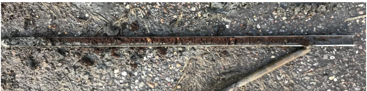
Het veen onder het ophoogpakket in boring 1
