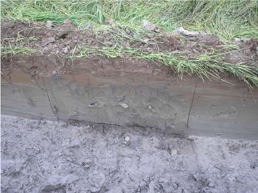
Figuur 2.1 Profiel op 6 m met onderaan de venige opvulling van een smalle geul (zuidelijke deel).
