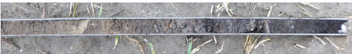
Figuur 13: Dronten, Oudebostocht Noord en Hondtocht Noord: Onder het veen (rechts) aangetroffen dekzand met podzolvorming (links) met in het midden de vernatte en doorwortelde top van het dekzand die is ontstaan in de beginfase van de veenvorming.
