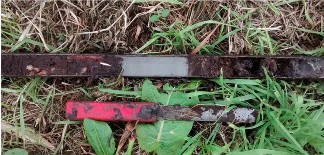
Afbeelding 9. Klapklei in boring 117. Let op de scherpe onder- en bovengrens van deze laag.
