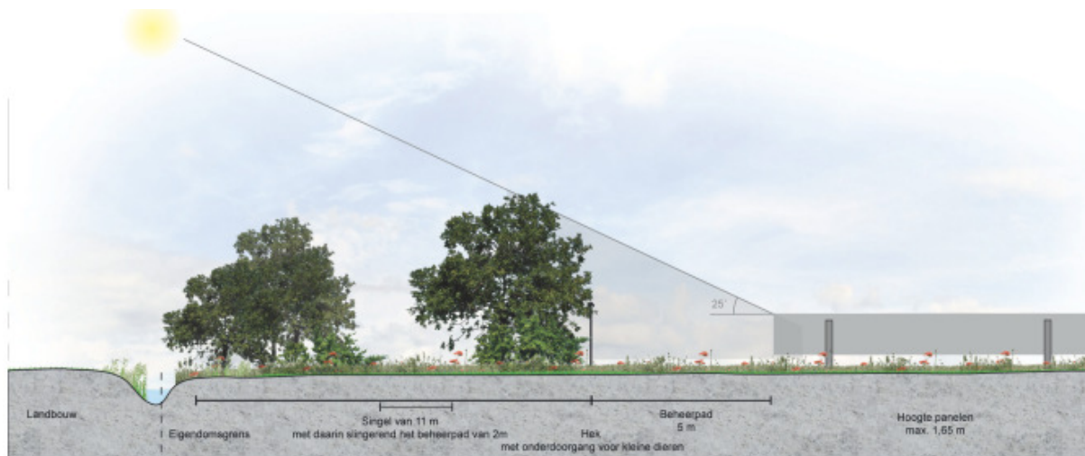
Afbeelding 2.4: Dwarsdoorsnede met rand met heesters (bron: Lujendijk & Van Hooft 2018)
