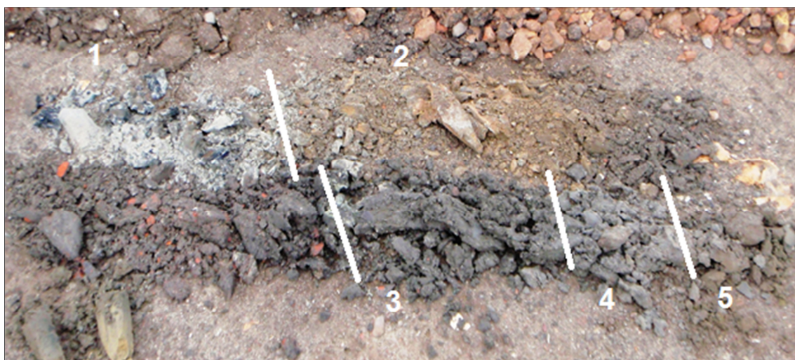
Afbeelding 7. Foto van boring 1, vanaf 30 cm-mv: 1: opgebracht stabilisatiezand, 2: opgebracht zand- en kleipakket met recent slooppuin, 3: kleiafzetting, met in top restant oude bouwvoor (10 cm dik), 4: dekzand (grijs), 5: dekzand (bruin)
