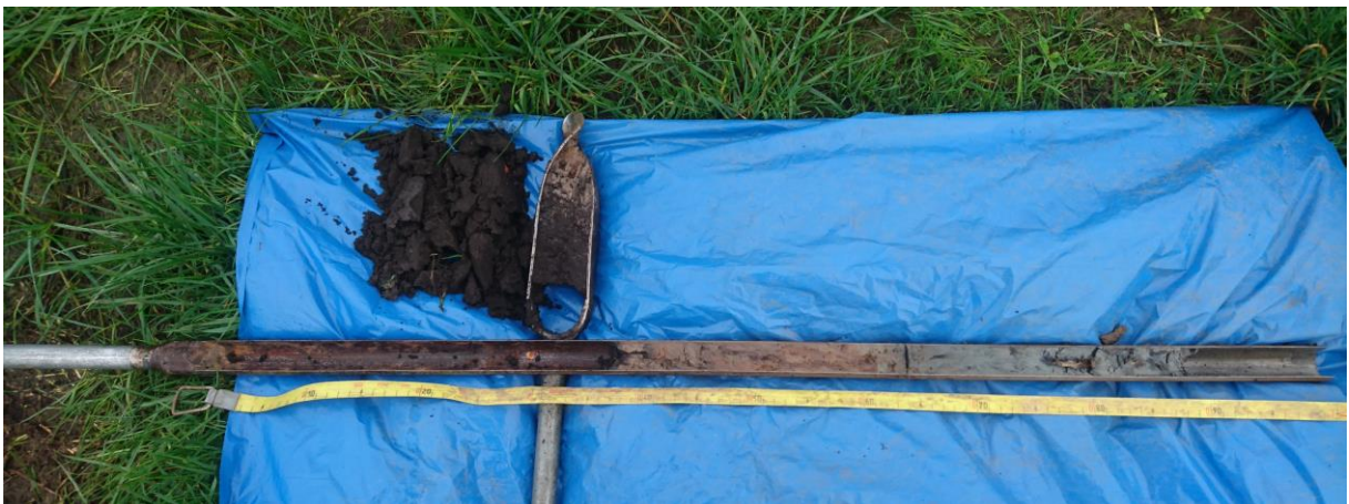
Boring 7 (0 – 90 cm): verploegd restveen met baksteen op Wormer-afzettingen.
