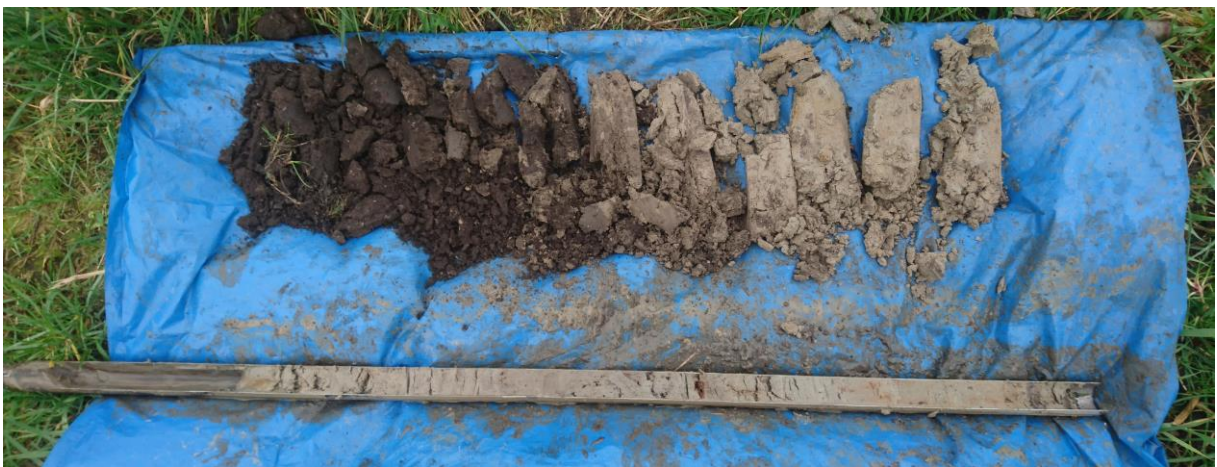
Boring 3 (0 -200 cm –mv): een bouwvoor met daaronder een geroerde laag (A/Cp-horizont) op overwegend zandige Wormer-afzettingen.
