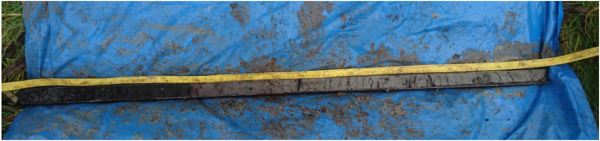
Boring 1 (100 – 200 cm –mv): de overgang van de geroerde veenrest, naar intact veen op Wormerafzettingen.
