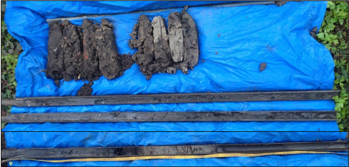
Boring 1: 0-400 cm -Mv. Per guts 100 cm. Het zand tussen 350 en 400 cm -Mv is uit de guts gelopen.
