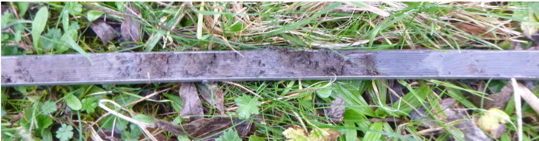
Figuur 8: Nieuwegein, Celsiusbaan. Door veenlaagjes onderbroken klei zoals deze in alle boringen is aangetroffen.
