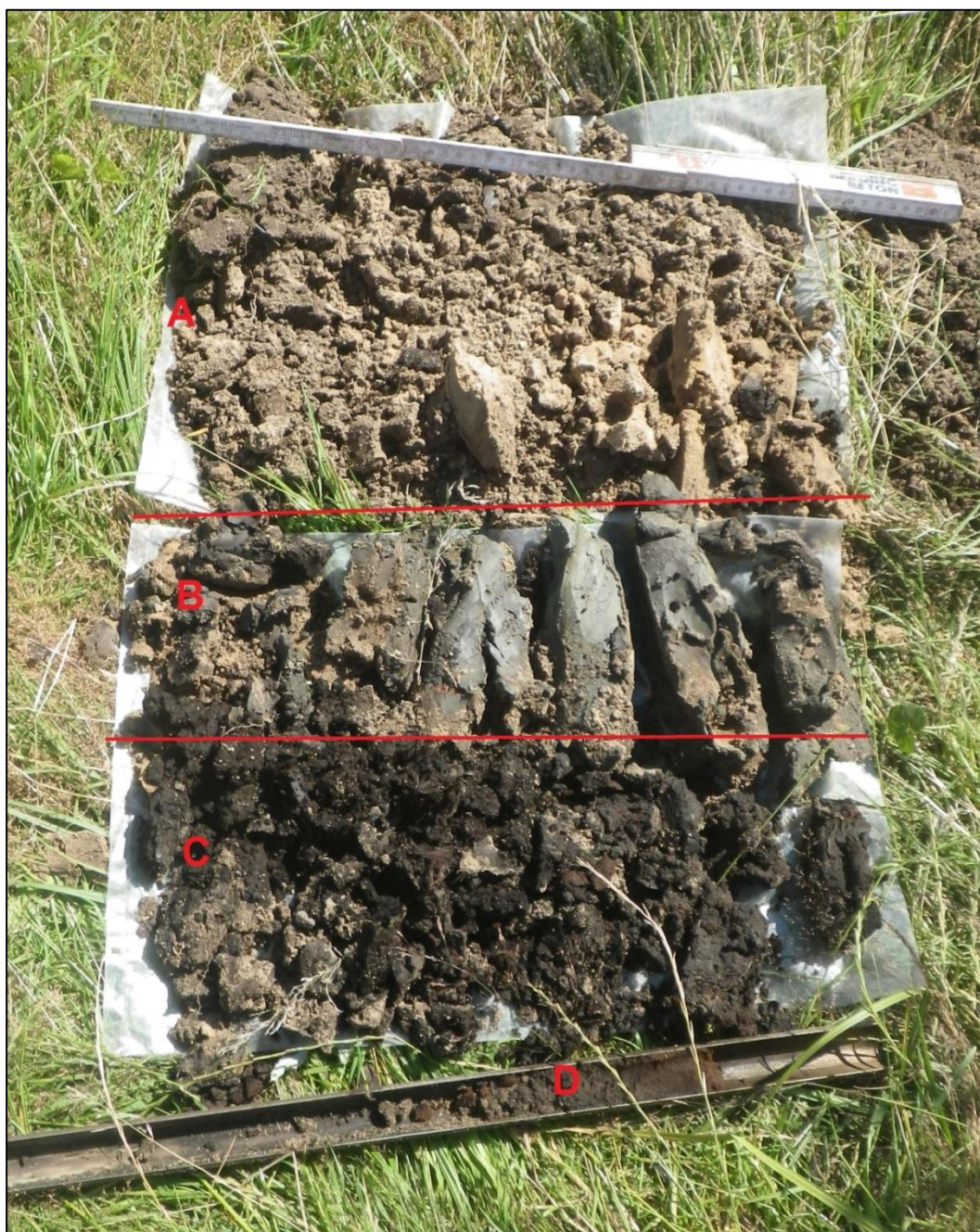
Afbeelding 11. Boring 4: A= recente ophoging, B= natuurlijke klei, C= veen, D= top dekzand (in guts)
