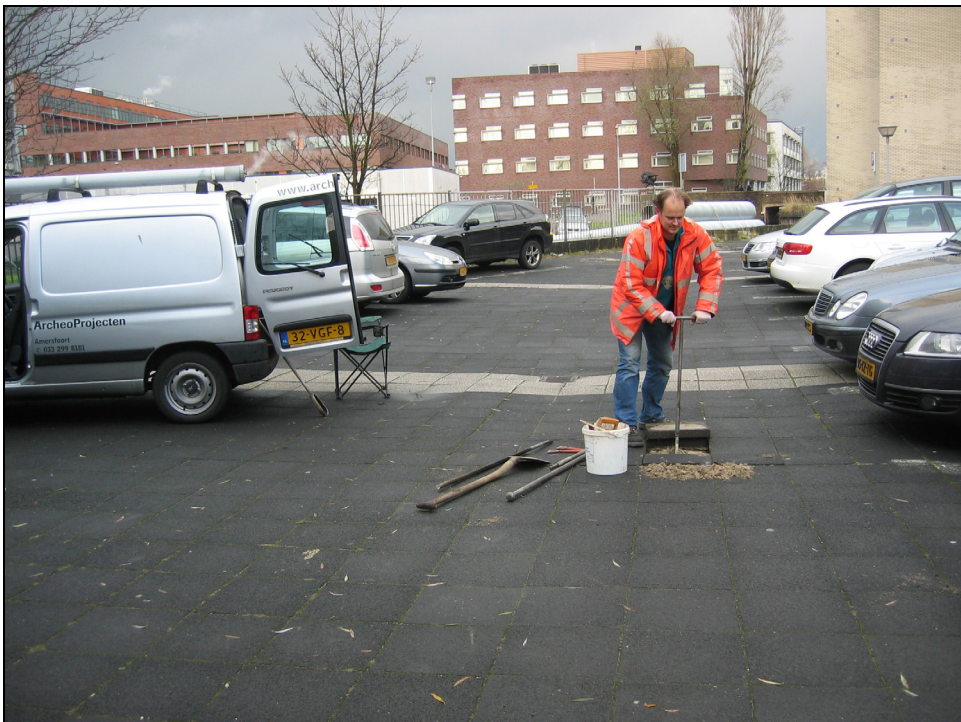
Afb. 6 Veldonderzoek: verwijderen van straatwerk door L. Haaring (boven) en zetten van een handboring door R.M. van der Zee (onder)
