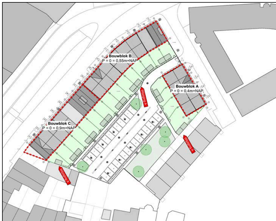
Afbeelding 4. De verkavelingsschets met betrekking tot de geplande nieuwbouw. Bron: Architectema, Architectuurstudio, d.d. 1 november 2018. Schaal 1: 1.000.
