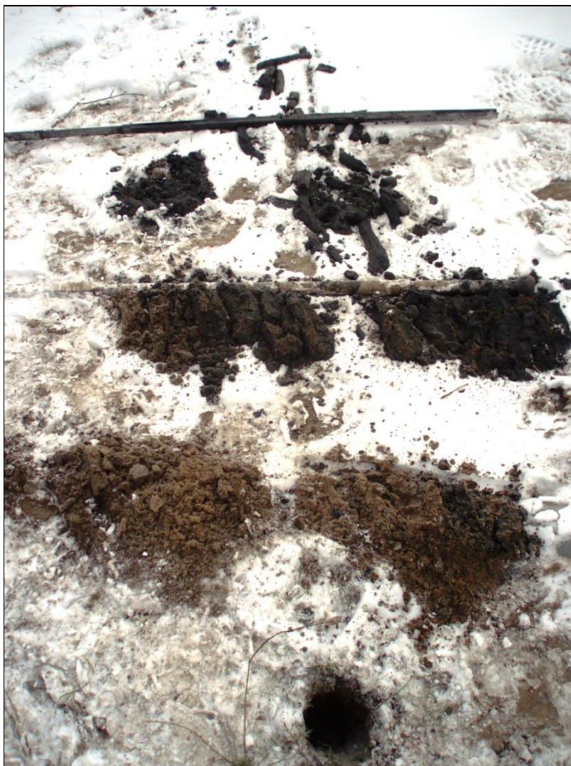
Afbeelding 10. Beeld van boring 1, de bovenste grondlagen liggen onderaan op de afbeelding
