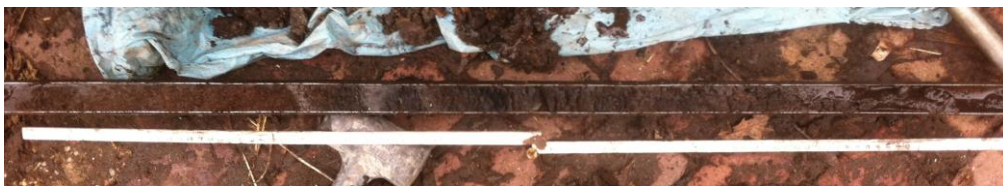
Opname van boring 4. In de top van de terplaag is een verdraaide elzenhouten paal aanwezig. Aan de basis is in de guts klei te zien, welke de basis vormen van de terplaag.
