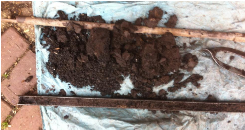
Opname van boring 4. In de top van de terplaag is een verdraaide elzenhouten paal aanwezig. Aan de basis is in de guts klei te zien, welke de basis vormen van de terplaag.
