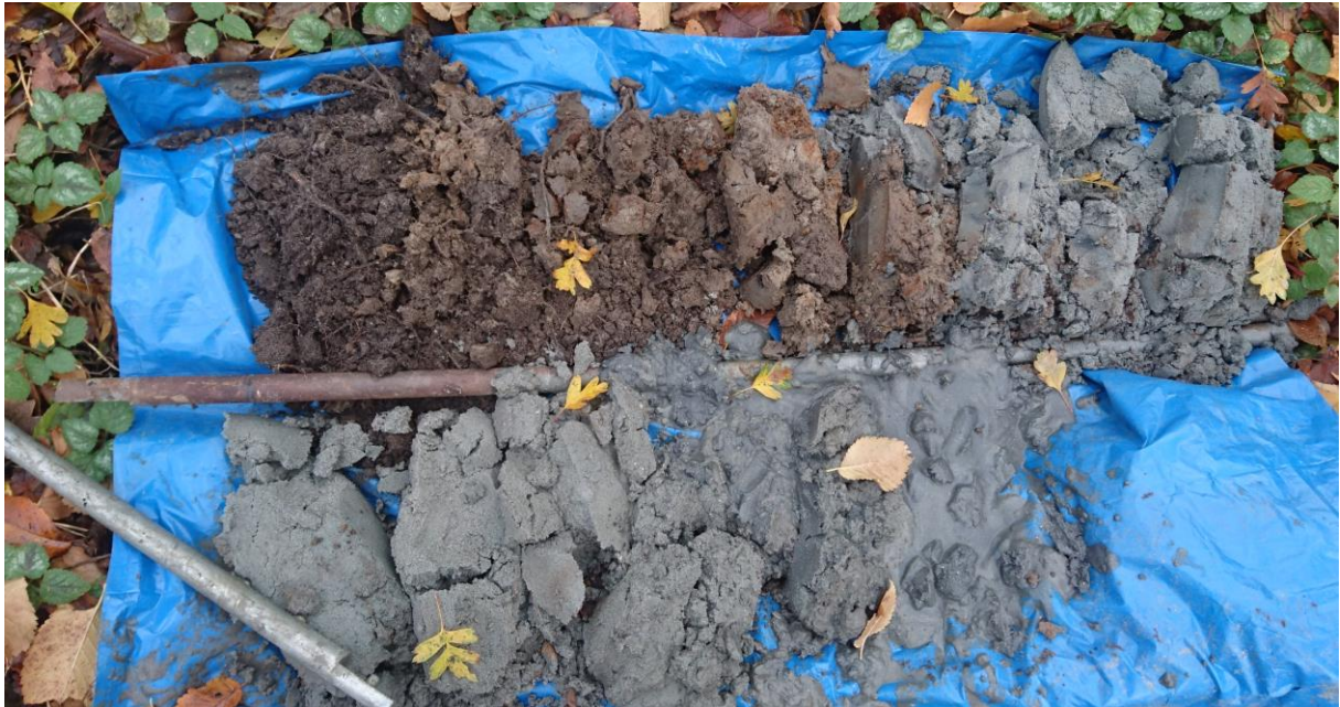
Boring 1: geroerde laag op grijs overstromingszand.
