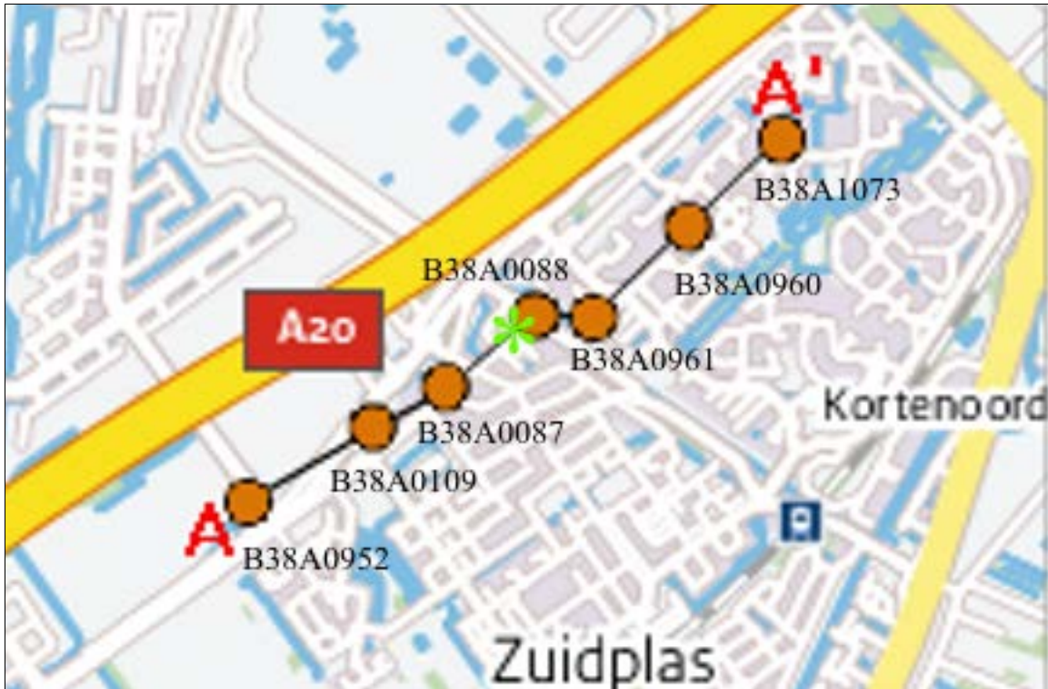
Afbeelding 7. Boorraai A - A', met de daarvoor gebruikte in het DINO-loket gearchiveerde boringen (zie Afbeelding 8 voor het dwarsprofiel). De ligging van het plangebied is gemarkeerd met een groene asterisk.
