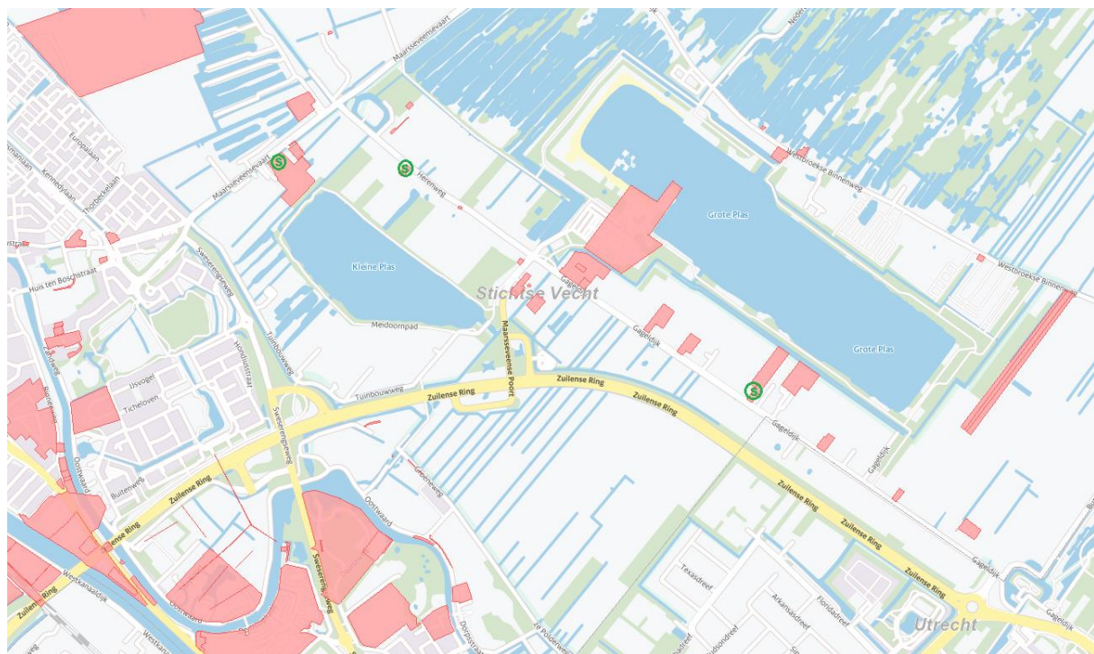
Afb. 12: Locaties met bodemverontreiniging langs de Maarsseveensevaart, Herenweg en Gageldijk, de locaties met de S in de groene cirkel zijn gesaneerd (bron: Bodemloket locatiecontouren bodemverontreiniging provincie Utrecht)
