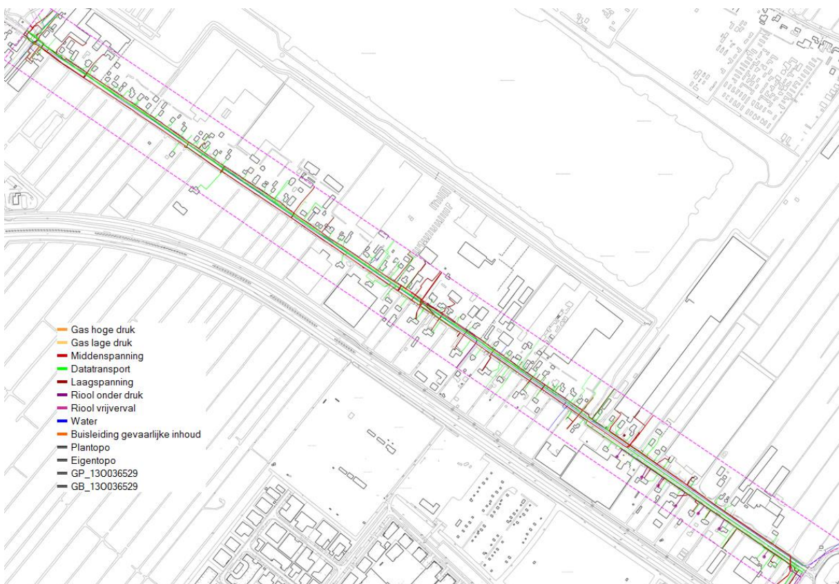
Afb.11: Kabels en leidingen langs de Gageldijk (bron: Kadaster)
