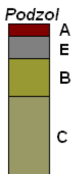
Afbeelding 4. Schematische weergave van een podzolbodem
