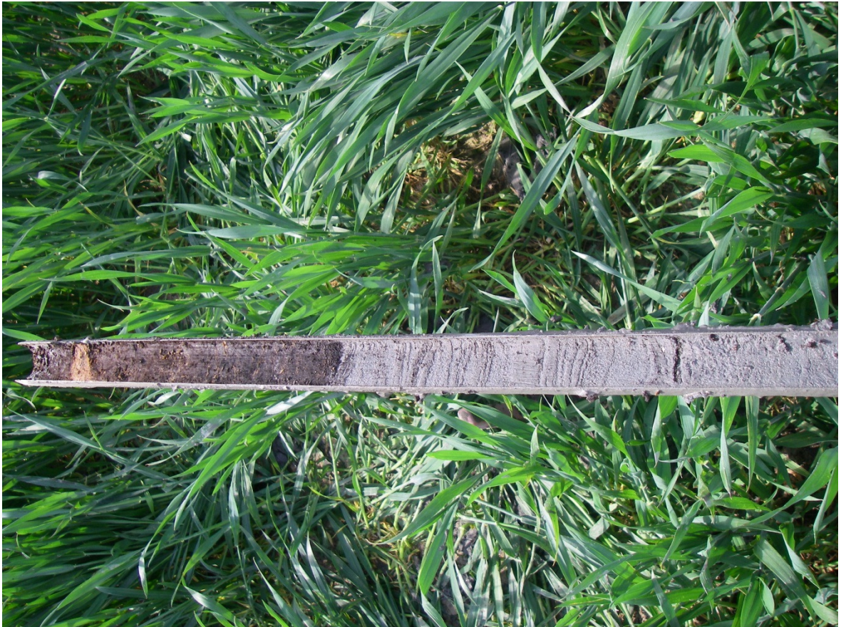
Afbeelding 3.1: Overgang Hollandveen Laagpakket naar het Laagpakket van Walcheren zoals aangetroffen in boring 9. De erosieve grens is duidelijk te zien, alsmede de houtresten die in het veen werden aangetroffen (foto: Synthebra).
