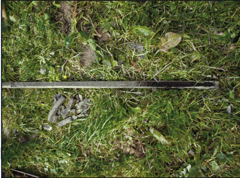
Afbeelding 5: foto van de onderzijde van boring 3. Te zien is de overgang van de D0 klei naar het Hollandveen.
