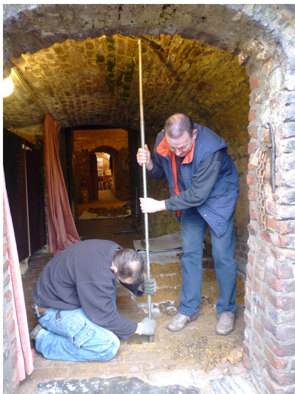
Figuur 5. De avegaarboor in werking.
