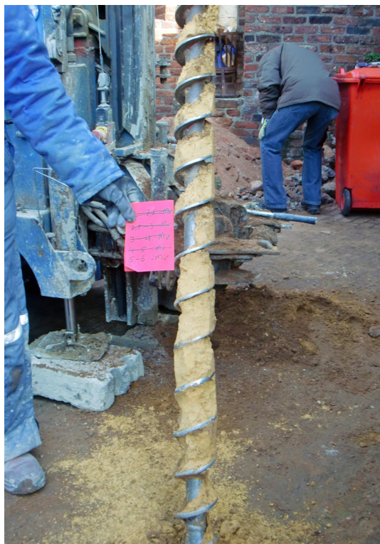
Figuur 8. De opbouw van het mottelichaam tussen 5 en 6 meter diepte.
