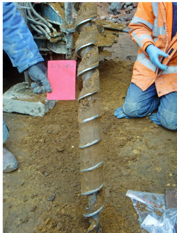
Figuur 9. De humeuze kleilaag tussen 6 en 7 meter diepte.
