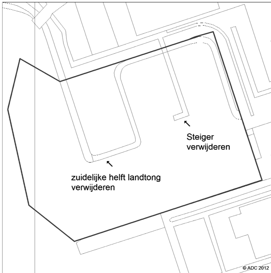
Afbeelding 3: Huidige situatie plangebied Berghaven met steiger en landtong. Het stuk havenkom, waarin de te verwijderen steiger ligt, wordt opgevuld met de vrijkomende grond van de half af te graven landtong. Het aldus ontstane oppervlak wordt grasland voor opslag van goederen en materieel.
