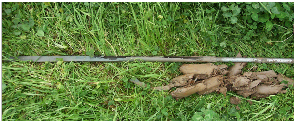
Afbeelding 3: Bodemopbouw in het westelijke deel met rechts de stugge bruin humeuze siltige klei van de bovengrond en links de slappe grijze klei van de moerassige afzettingen.
