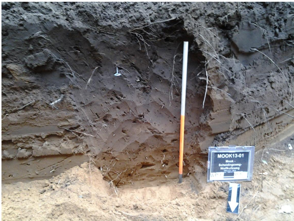
Figuur 3: Profiel in proefsleuf 2, aangetroffen zijn een A-, B- en C-horizont.
