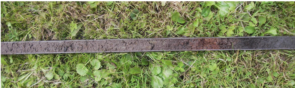
Figuur 5. Britsum, De Kamp. Foto van boring 4 met links de geroerde bovengrond, rechts van het midden gebakken klei en geheel rechts kleiig veen dat mogelijk het restant is van een pakket samengedrukte kwelderplaggen.
