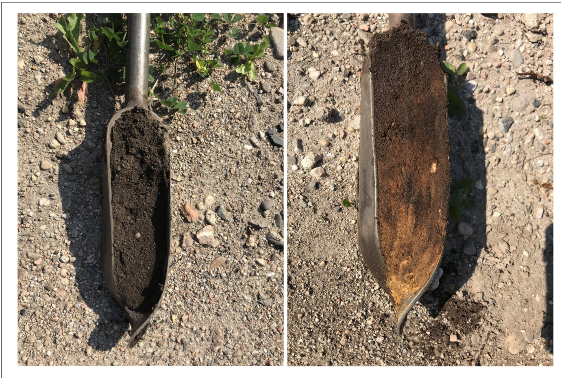
Figuur 16: Apeldoorn, Maria Stuartstraat (west van huisnummer 75): Afbeelding met links de opgeboorde grond uit boring 6 op een diepte van 80 centimeter beneden maaiveld met het espakket. Rechts: de opgeboorde grond uit boring 6 met de restanten van een podzoldodem (B/C- horizont) op een diepte van circa 100 centimeter beneden maaiveld.
