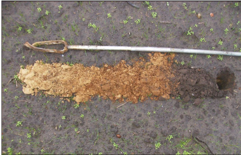
Afbeelding 7 Beeld van boring 1 met de verstoorde bodemlaag, donkergeel met lichte vlekken.
