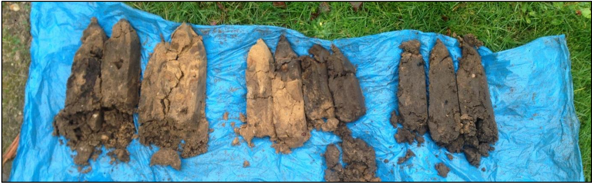
Boring 11: 0-130 cm -Mv. Meermaals gestaakt in puinlaag op 110-130 cm -Mv.
