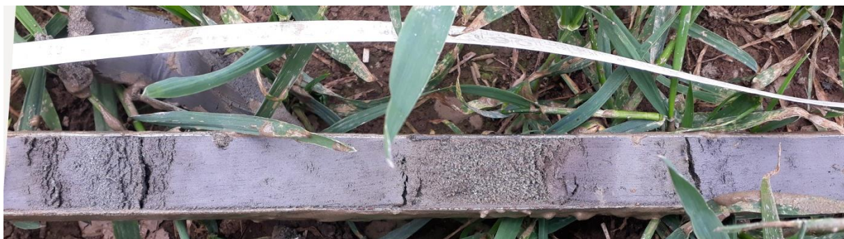
Afbeelding 3.3.2: Detail van het met een guts geboorde diepe deel van boring 4. Hier zijn afwisselingen van laagjes schoon zand en zandige klei en donkere humeuze waterbodems te zien. De guts is 2 cm breed.
