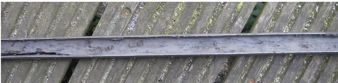
Figuur 7. Zaandam, Hogendijk 134. Foto van de zwak venige klei zoals deze in de boringen 4 tot en met 7 vanaf ongeveer een meter beneden het maaiveld is aangetroffen.
