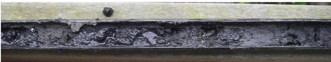
Figuur 8. Zaandam, Hogendijk 134. Foto van het organisch bezinksel zoals dit in de boringen 1 tot en met 3 is aangetroffen.
