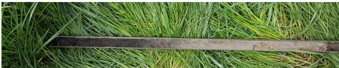
Afbeelding 10 Bodemprofiel van boring 10 ter hoogte van de overgang van de oeverafzettingen naar het Hollandveen. Het veen begint op diepte van 1,7 m -mv. Bron: foto Vestigia (18-05-2016).
