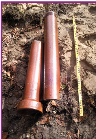
Afbeelding 24. Aangetroffen gresbuizen met merktekens (gem. Arnhem).
