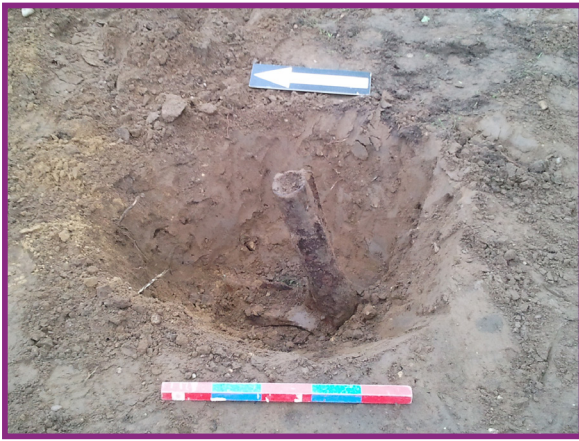
Afbeelding 26. Verwongen voorzijde van de geëxplodeerde RP-3-raketbuis in de voorzichtig uitgegraven inslagkrater (gemeente Arnhem, richting oost).
