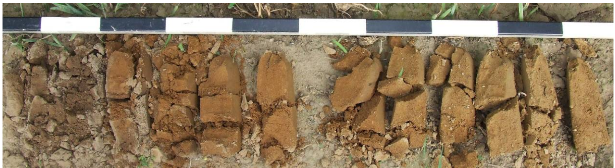
Figuur 25: Foto van een referentieboring ten zuidoosten van Brachtbeek in een zone waar volgens de bodemkaart holtpodzolen in rivierafzettingen voorkomen. Het bodemmateriaal bevat hier minder leem en de B-horizont is relatief zwak ontwikkeld.
